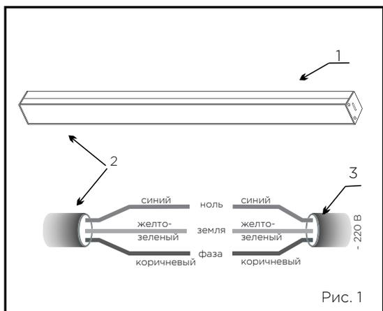
Светильник FDL 1 (рис.1) монтируется к верхнему основанию, потолку или стене, либо на подвес.
