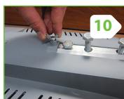
Зафиксировать защитную крышку винтом (барашком)
