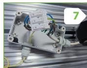
Подсоединить сетевые провода к клеммной колодке (проводы круглого сечения диаметром не более 8 мм)
